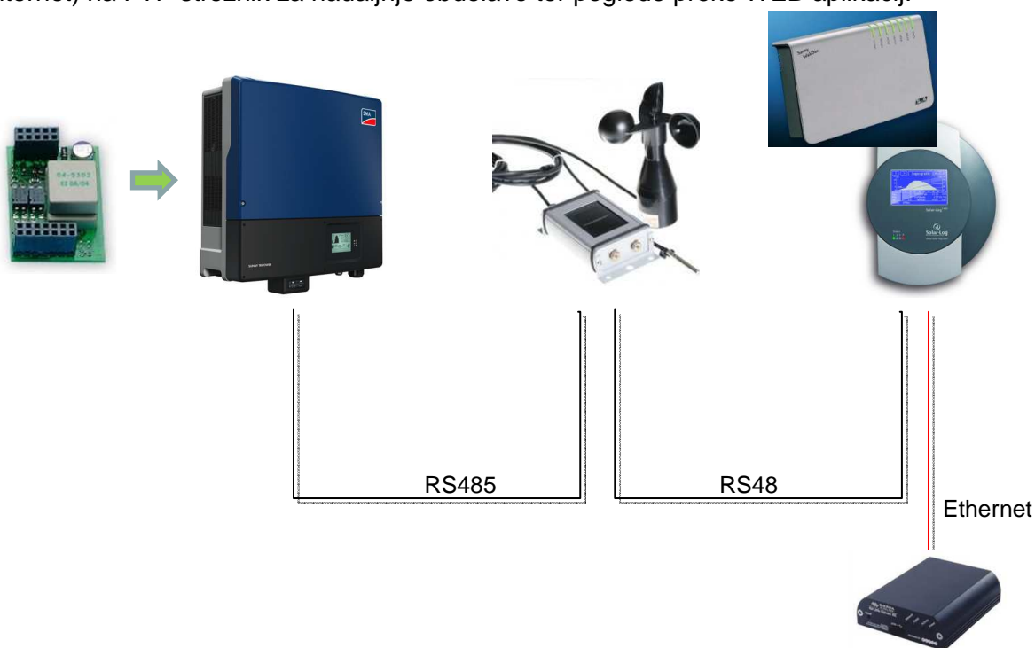
Slika 3: Osnovna konfiguracija monitoringa sončnih elektrarn od zajema do pregleda podatkov
