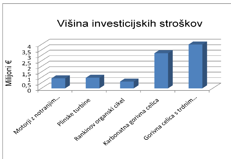
Slika 8: Višina investicije za posamezen tip naprave Vir: (povzeto po Bove and Lunghi, 2006)
