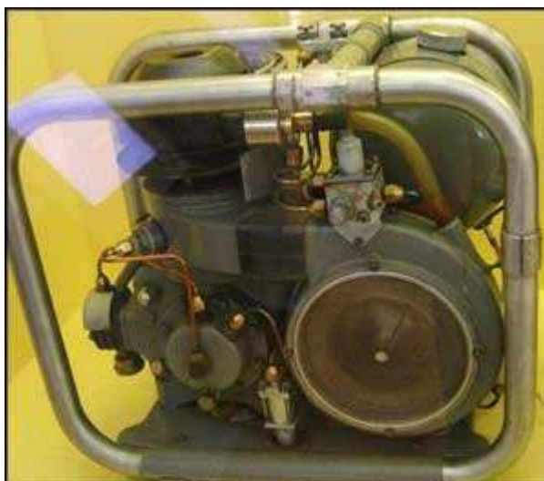
Slika 5: Stirlingov motor
