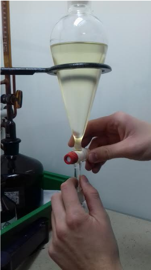
Slika 4: Postopek ločevanja glicerola od biodizla
