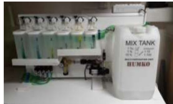
Majhna postaja za gnojenje in namakanje s šestimi različnimi gnojili, aktivatorji, kislinami itd.
