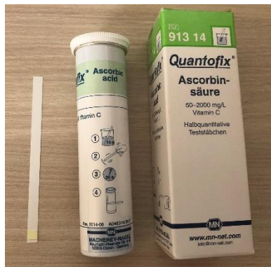
Slika 4: Testni lističi MN-91314 za določanje vsebnosti askorbinske kisline s prikazanim postopkom na posodici Vir: Lasten
