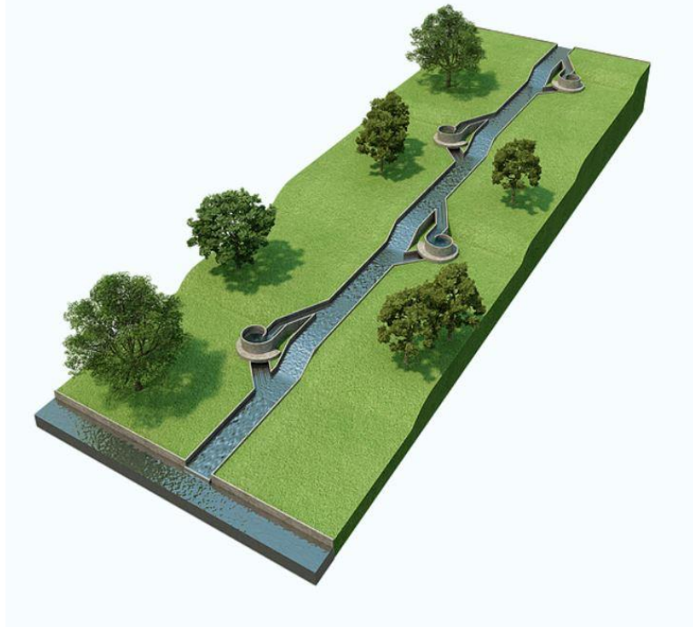
Slika 2: Več zaporedno postavljenih vrtničnih mikro hidroelektrarn
