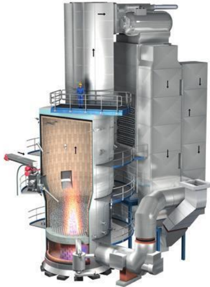
Slika 2: Stacionarna peč s tehnologijo v zvrtničenem sloju Vir: Zürich, 2015
