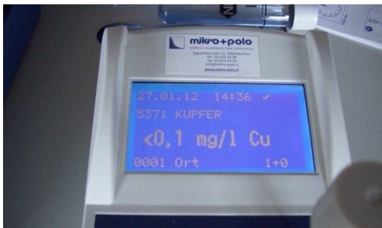
Slika 5: Spektrometrična določitev bakrovih ionov v filtratu
