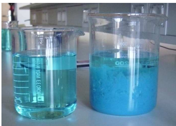
Slika 4: Nastanek oborine bakrovega hidroksida v raztopini
