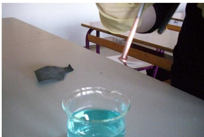
Slika 2: Pobakren žebelj med postopkom
